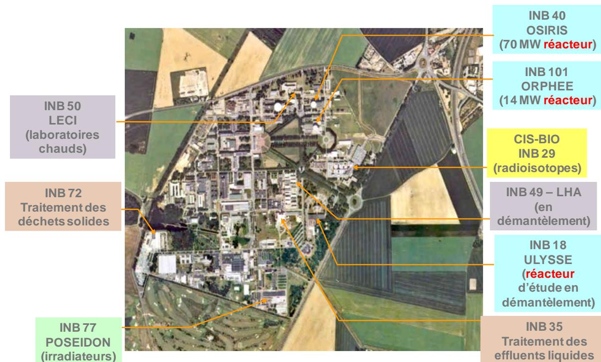
Figure n°1 : les installations nucléaires de base implantées sur le site de Saclay
