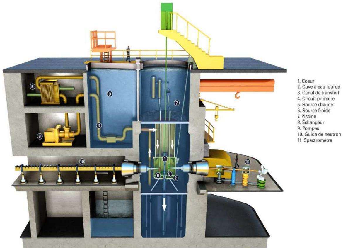
Figure 4 : vue en éclaté du bloc pile du réacteur ORPHEE
