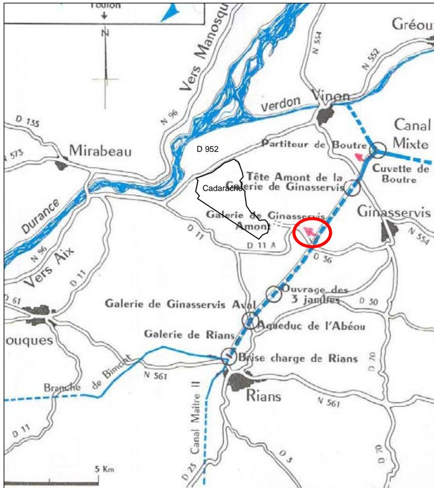
Figure 8 : implantation du canal de Provence
