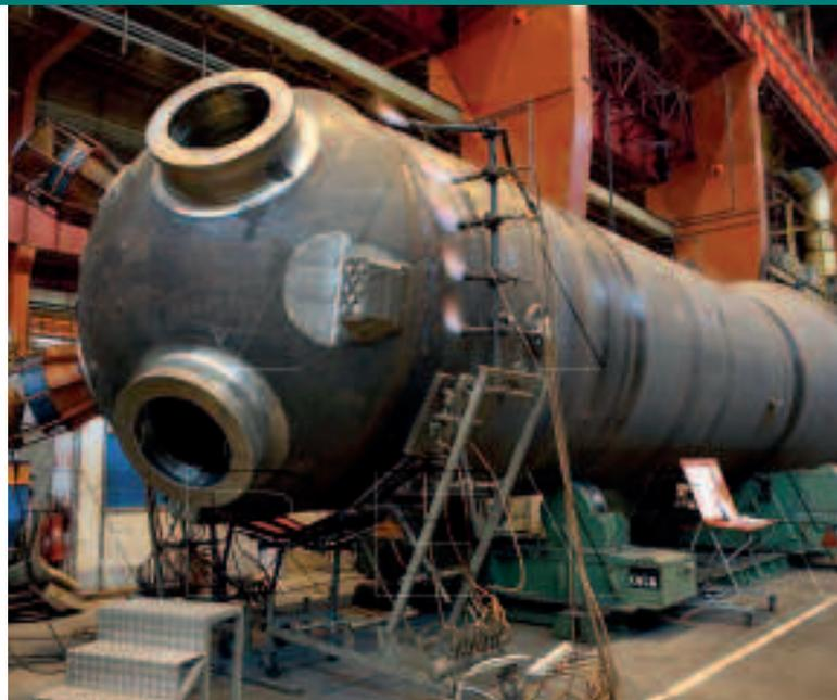
Figure 2 : générateur de vapeur en cours de fabrication
