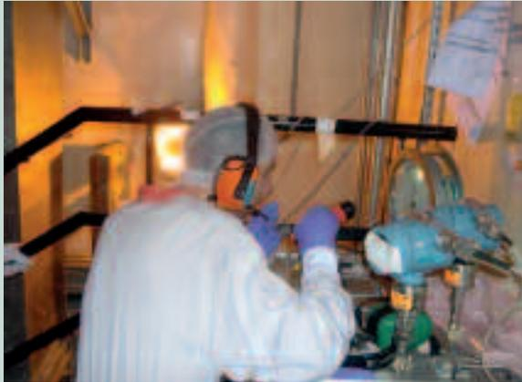
Suivi de la mesure de pression lors de l'épreuve hydraulique du circuit primaire principal du réacteur 2 de Cattenom en 2008
