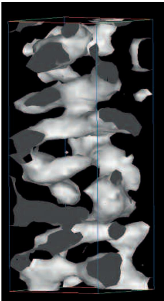
Figure 1 : image en 3-D obtenue par sonde atomique tomographique des zones riches en Cr à l'intérieur de la ferrite vieillie thermiquement, volume analysé : 15x15x50 mm
