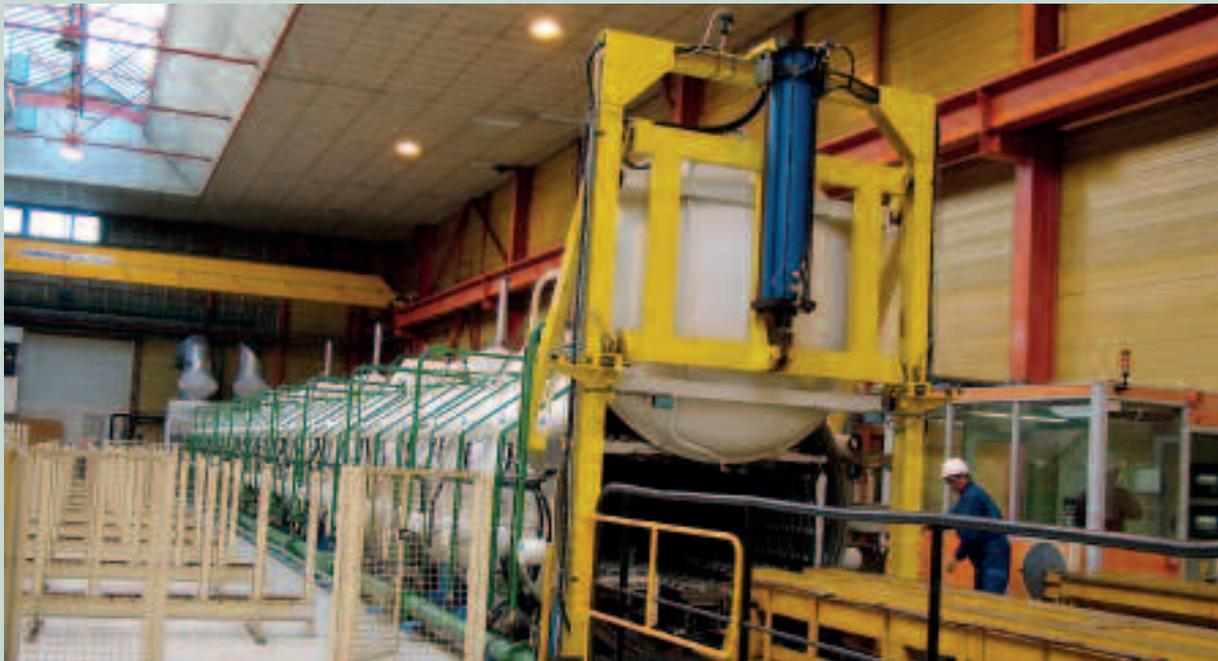
Four sous vide mesurant 30 mètres de long sur 1 mètre de large
