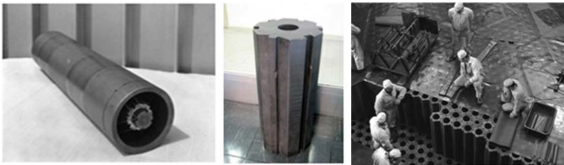
Figure 7 (a) Chemise graphite (à gauche) (b) Brique de graphite d'empilement (au centre), (c) empilement graphite du réacteur EDF Chinon A3 en cours de construction en 1965 (à droite)
