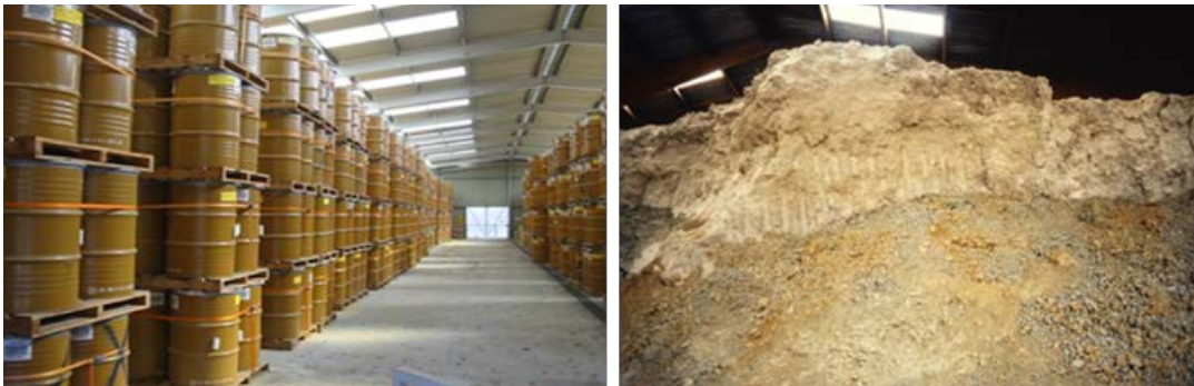
Figure 2 Entrepôt des fûts de RRA de Solvay (Cadarache) et des résidus solides banalisés de Solvay (La Rochelle)
