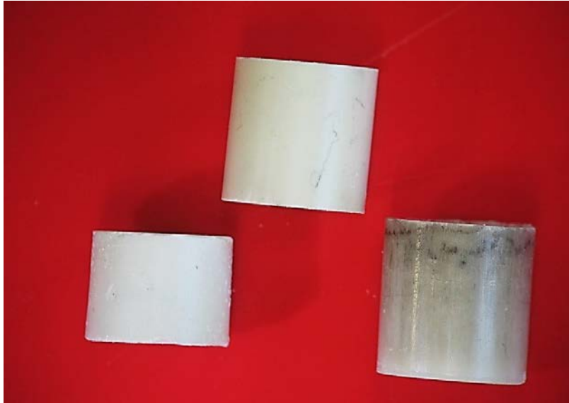
Pastilles de thorium frittées à partir de poudres de ThO 2 , avec des densités entre 83 et 92%TD.
