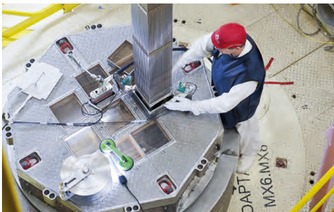
Assemblage combustible MOX en cours de chargement dans un conteneur de transport à l'usine Mélox de Bagnols-sur-Cèze.
