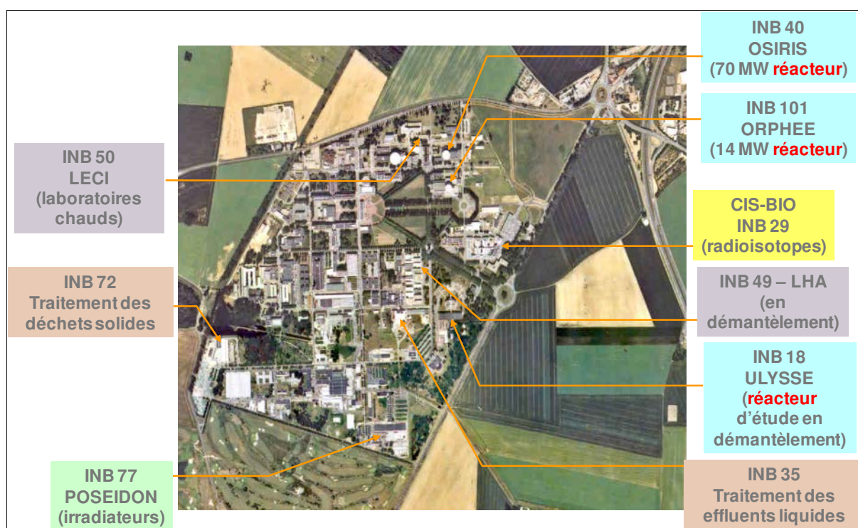
Figure 1 : Installations nucléaires de base implantées sur le site de Saclay
