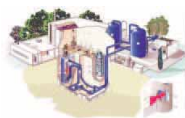
Vue schématique du réacteur CABRI avec la boucle à eau sous pression
