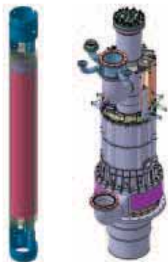
Le caisson cœur dans son environnement immédiat : posé sur la boîte à eau et avec le réflecteur béryllium en place
