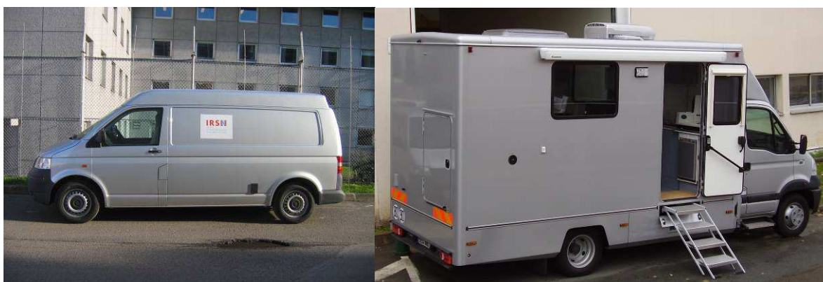
Figure 20 - Véhicule léger d'intervention (à gauche) et laboratoire mobile (à droite) de mesure de la radioactivité d'échantillons environnementaux (IRSN).
