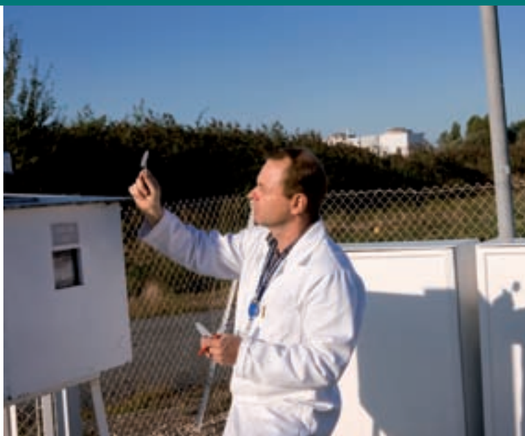
Surveillance de l'environnement à la centrale nucléaire du Blayais – Prélèvement d'un filtre àérosol
