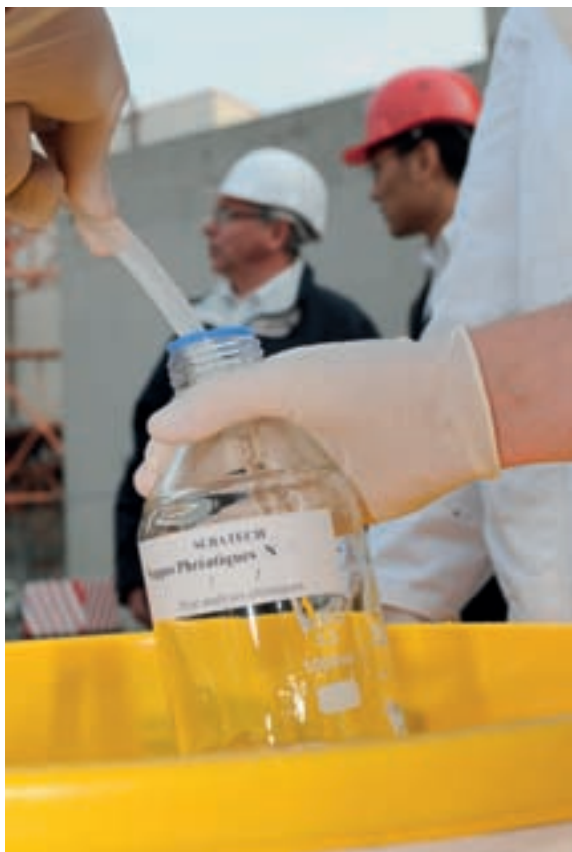
Inspection avec prélèvement dans le piézomètre n° 5 de la centrale nucléaire de Gravelines (Nord)
