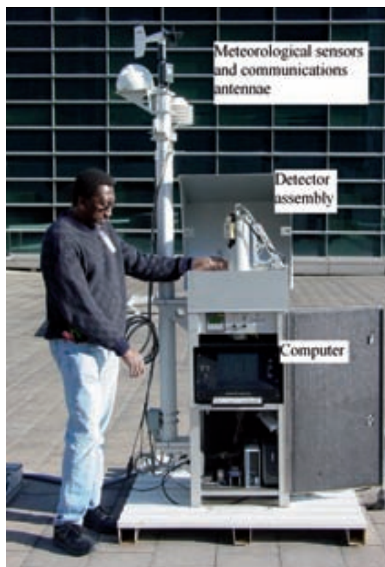
Figure 7 : un système fixe de surveillance RadNet comprend des capteurs météorologiques (température ambiante, pression barométrique et direction/vitesse du vent en option), un échantillonneur d'air haut débit (60 m 3 /heure), des détecteurs de rayonnement (détecteur au silicium ionisé pour la mesure des rayons bêta et détecteur NaI 5 x 5 cm pour la mesure des rayons gamma), un ordinateur et un équipement de télémétrie (large bande sans fil, satellite, réseau local, modem analogique). L'ordinateur commande l'acquisition des données et permet le transfert des données et l'accès à distance de l'EPA
