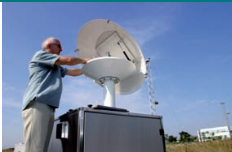
Station d'aérosols – Prélèvement d'aérosols atmosphériques sur un filtre (500 m 3 /heure)
