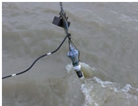
Figure 3 : système de détection mobile "Téléhydro" dédié à des constats radiologiques ponctuels (mesures en aval de rejets hospitaliers, intervention en situation de crise...)
