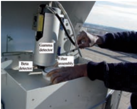
Figure 8 : précision de la mesure maximisée par l'installation géométrique des détecteurs et du filtre à air. L'ensemble détecteur pivote vers l'extérieur (comme indiqué) lors du changement de filtre
