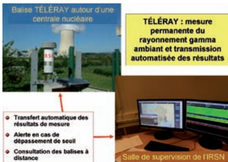
Figure 1 : balise Téléray implantée à la clôture d'une centrale nucléaire et liaison avec la salle de supervision de l'IRSN
