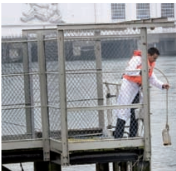
Prélèvement d'eau – Centrale nucléaire de Fessenheim
