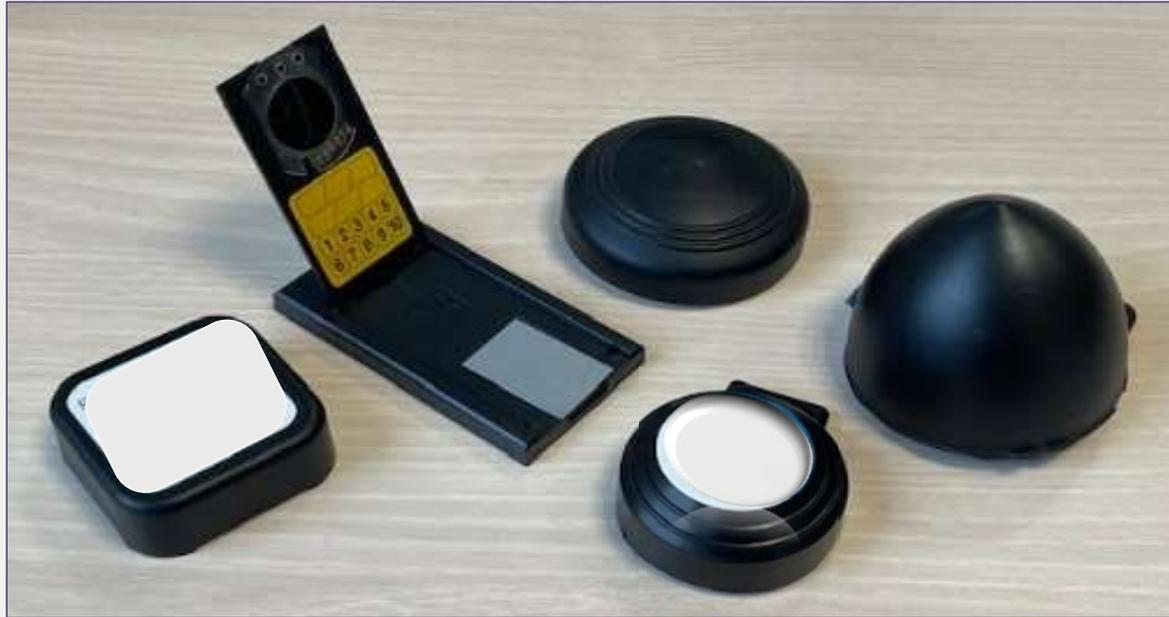
**Avec des détecteurs de radon placés 2 à 3 mois, d'octobre à avril, dans des endroits représentatifs de l'exposition des travailleurs.**
