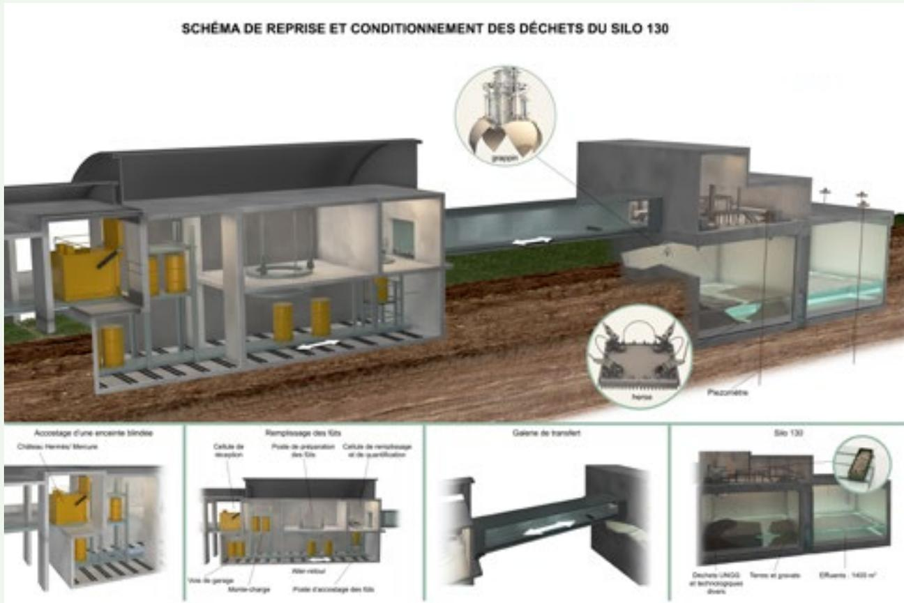
Un autre facteur pouvant compromettre la sûreté du silo 130 est lié à la nature des substances présentes dans les déchets, comme le magnésium, qui est pyrophorique. L'hydrogène, gaz hautement inflammable, peut aussi être produit par des phénomènes de radiolyse ou de corrosion (présence d'eau). Ces éléments contribuent aux risques d'incendie et d'explosion.
