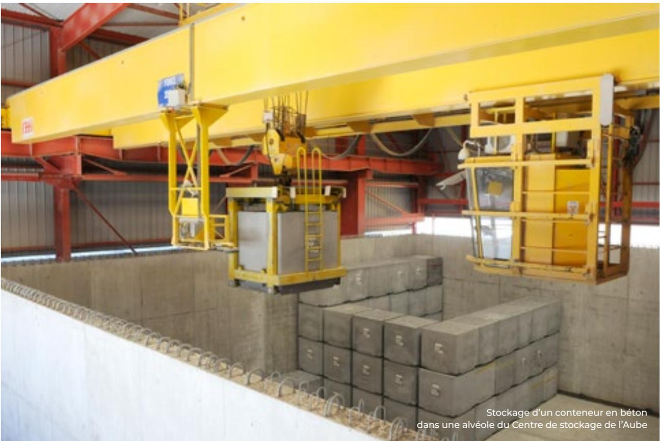
Stockage d'un conteneur en béton dans une alvéole du Centre de stockage de l'Aube
