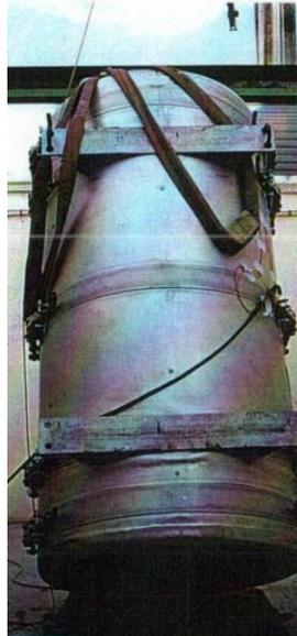
Les flux de fuite mesurés à l'issue de ces deux dernières chutes montrent le maintien de l'étanchéité du cylindre.
