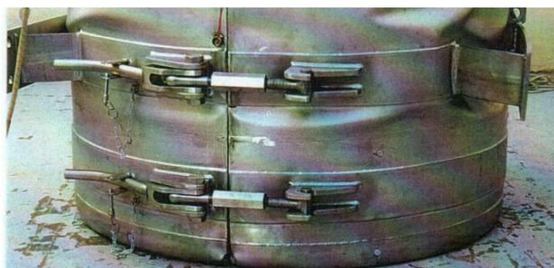
La 4<sup>ème</sup> chute est une chute libre de 1 mètre de hauteur sur poinçon cumulée au même endroit que celui de la 3<sup>ème</sup> chute. Pour ce cas de chute avec angle (voir photo ci-dessous), la zone du colis testée correspond à la vanne du cylindre.
