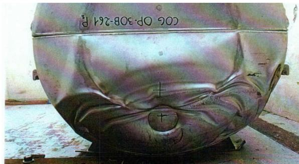
Les flux de fuite mesurés à l'issue de ces deux premières chutes montrent le maintien de l'étanchéité du cylindre.
