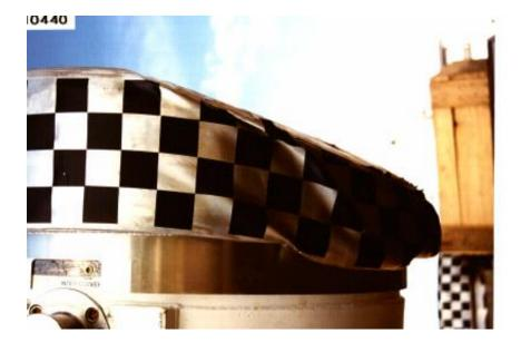
À la fin de la séquence de chute, les mesures d'étanchéité normalisées par gaz traceur Hélium montrent que les deux barrières de la maquette n°1 conservent un bon niveau d'étanchéité.
