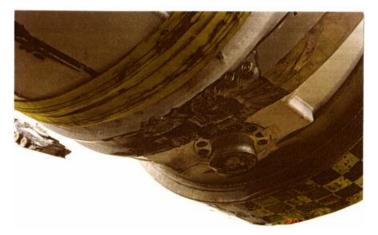
À la fin de la séquence de chute, les mesures d'étanchéité normalisées par gaz traceur Hélium montrent que les deux barrières de la maquette n°1 conservent un bon niveau d'étanchéité.
