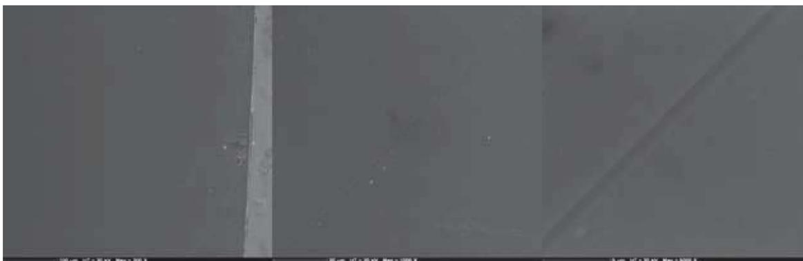
Figure 6 : Microstructure du verre dopé à 3.25% massiques en  $^{244}\text{CmO}_2$  après une dose de  $2 \times 10^{19}$  α/g
