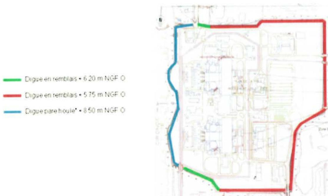
Figure 3 : Tracé de la protection inondation externe existante.
