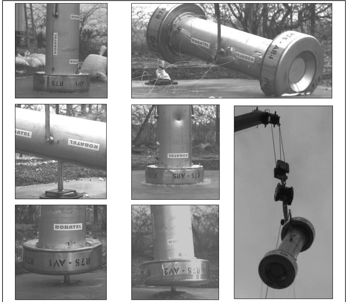
Campagne d'essais de chute de la maquette du modèle de colis R75 :
