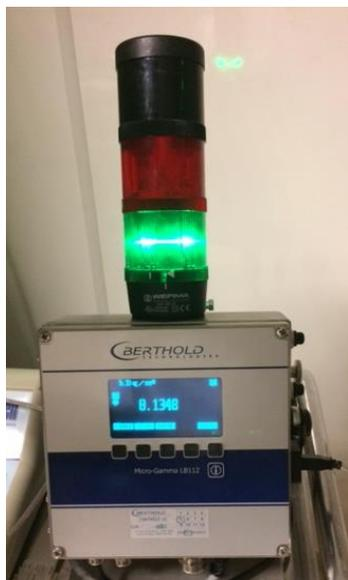
La sonde utilisée est la sonde de marque Berthold modèle LB112. Le boîtier permettant la mesure est situé sur le frigo.
