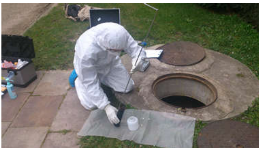
Fig. 13 – Prélèvement d'un échantillon par l'IPHC Strasbourg (CNRS) le 24/03/2016 pour analyse spectrométrique gamma préalable à une vidange de la fosse septique de l'Hôpital de Hautepierre.
