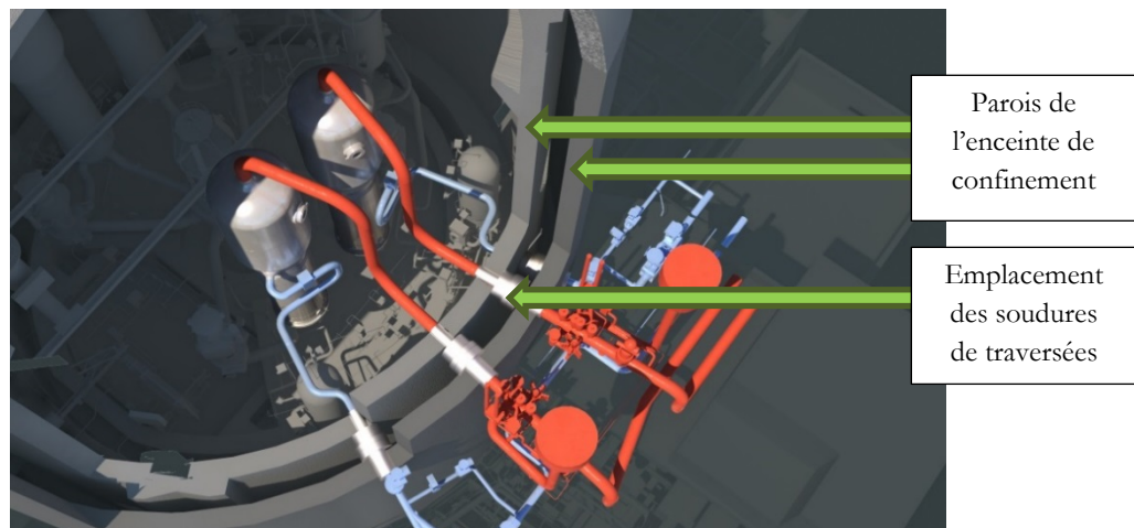
Vue d'ensemble des tuyauteries VVP (représentées en rouge)
