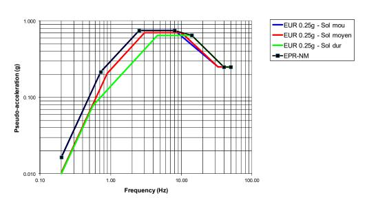
EPR-NM - Séisme DBH Spectre de sol
