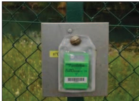
Figure VI. 3.6 : Film dosimétrique thermoluminescent
