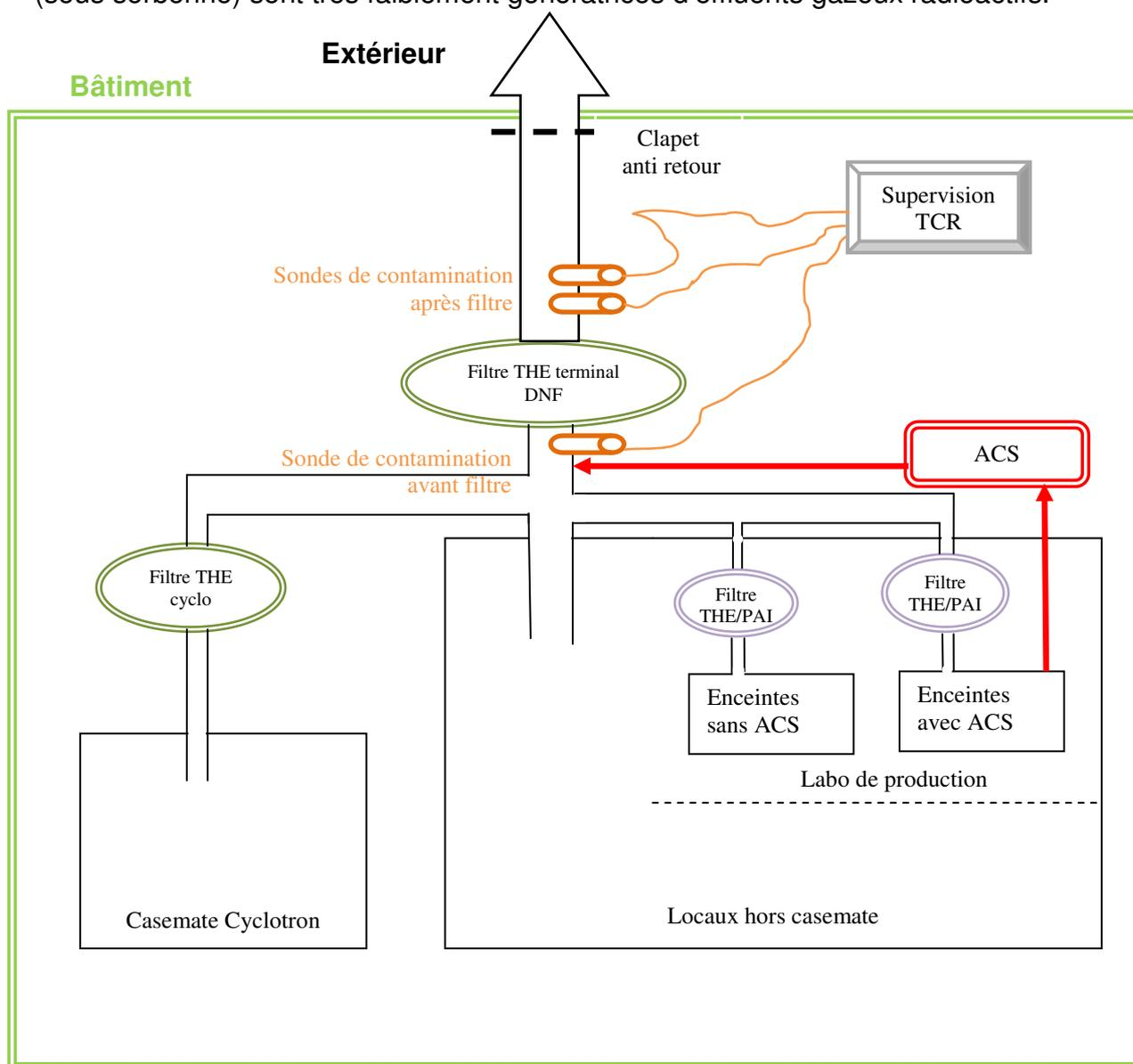
Schéma de principe simplifié de la ventilation n'incluant pas tous les organes de régulation et de sécurité correspondant à une unité de production.
