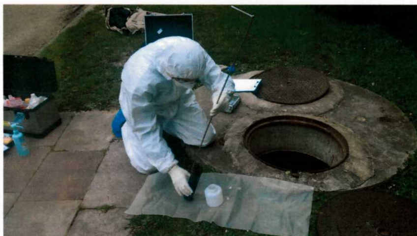
Fig. 10 – Prélèvement d'un échantillon par l'IPHC Strasbourg (CNRS) le 24/03/2016 pour analyse spectrométrique gamma préalable à une vidange de la fosse septique de l'Hôpital de HautePierre.
