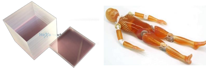
Modélisation du patient (diffusant en PMMA ou fantôme anthropomorphe)
