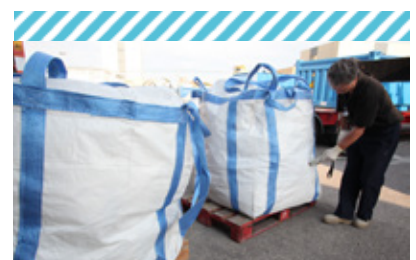
Exemple d'emballage de déchets TFA (très faible activité)
