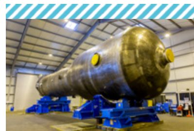
Générateur de vapeur destiné à être utilisé par les réacteurs à eau pressurisé d'EDF
