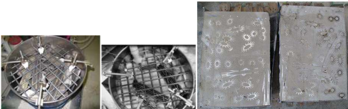
Figure 5. Gaines magnésiennes simulantes inertes mises en vrac dans le fût inox de 223L (gauche), remplissage du coulis Géopolymère (centre), vue après découpe de la structure du colis de gaines magnésiennes conditionné par enrobage (droite).
