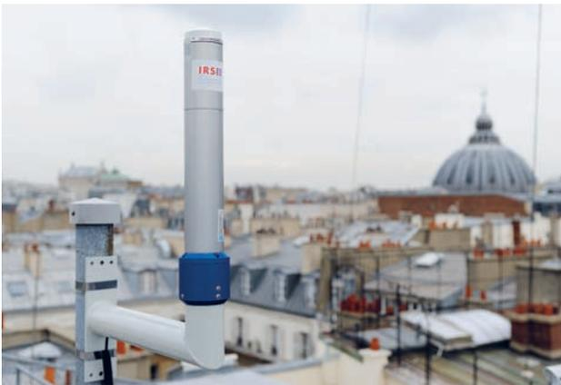
Balise IRSN nouvelle génération du réseau Télecray, dispositif de surveillance de rayonnement gamma ambiant en France installé à Paris sur le toit de l'état-major de la Marine
