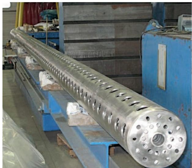
Réception des thermoplongeurs sur l'installation PHÉNIX
