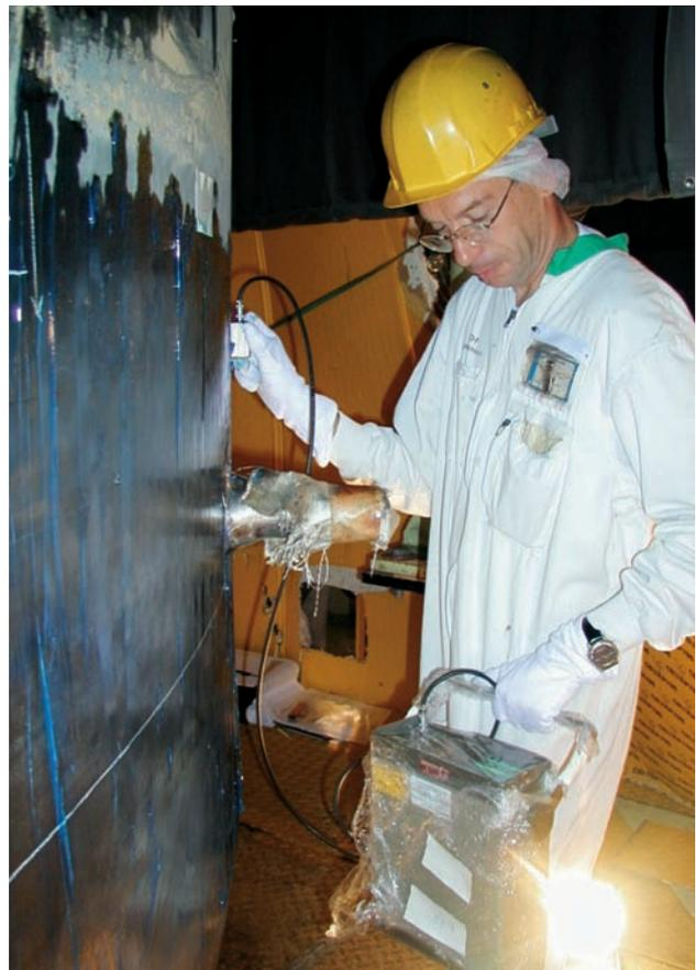
Contrôle par ultrasons d'un joint soudé
