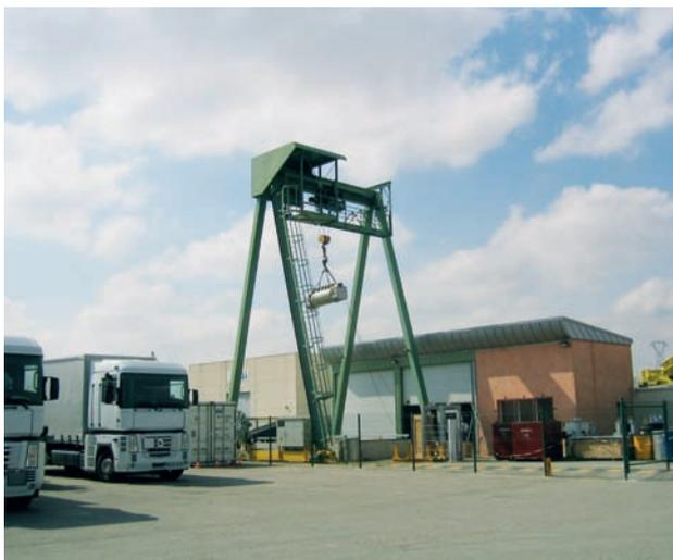
Essai de chute d'un emballage destiné au transport de combustibles usés
