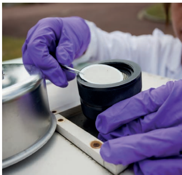
Mise en place d'un filtre sur une station du réseau de prélèvement des aérosols « OPÉRA-AIR » de l'IRSN (programme OPÉRA : Observatoires PErmanents de la RAdioactivité de l'environnement)
