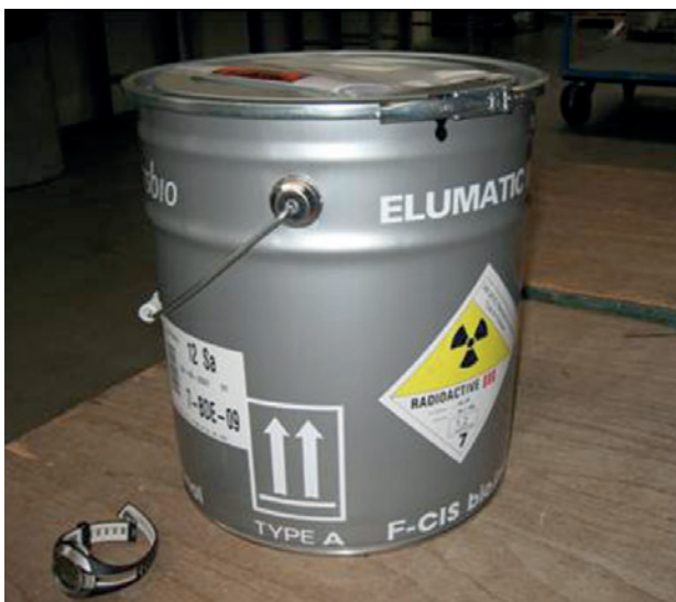
Exemple d'un emballage de type A – générateur de technétium 99m
