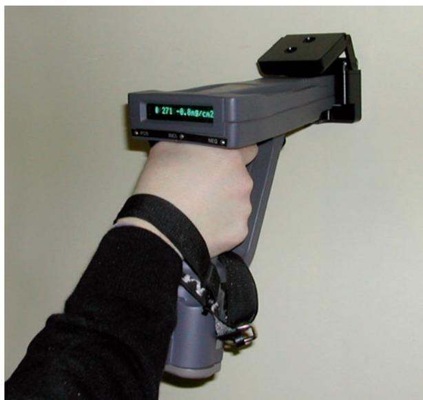
Appareil de détection de plomb dans les peintures
