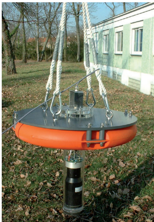
Dispositif de mesure de la radioactivité des eaux usées
