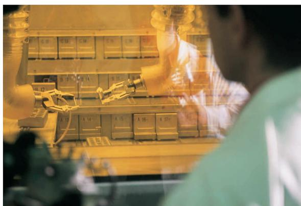
Opérateur manipulant par téléopération des matières radioactives dans une cellule du LECI à Saclay (Essonne)
