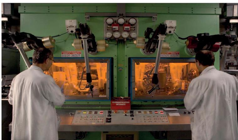
Opérateurs manipulant par télé-opération des matières radioactives dans des cellules d'ATALANTE à Marcoule (Gard)
