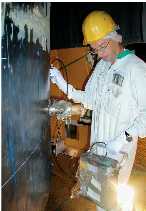
Contrôle par ultrasons d'un joint soudé
