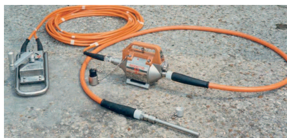
Appareil de gammagraphie – CEGELEC – et ses accessoires (télécommande, gaine d'éjection, embout d'irradiation)
