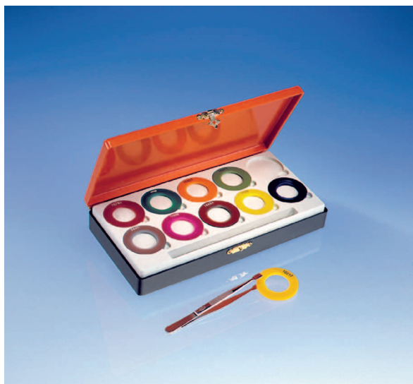
Coffret de sources gamma fabriquées au LEA. Les radionucléides proposés sont Am241, Cd109, Ce139, Co57, Cr51, Cs137, Mn54, Sn113, Sr85, Zn65
