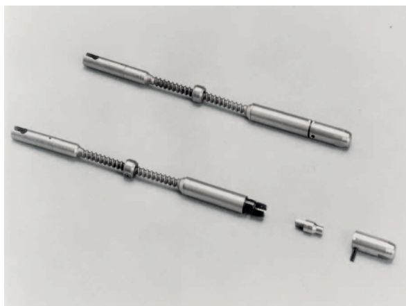
Assemblage source et porte source contenu dans un appareil de gammagraphie – CEGELEC
