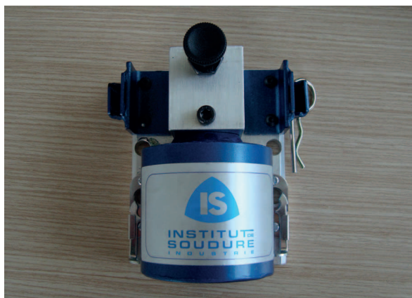
Le dispositif gamma-prox (collimateur) complémentaire à des appareils de gammagraphie permet une optimisation de la radioprotection
