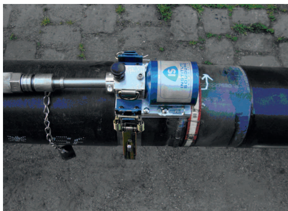
Le dispositif gamma-prox (collimateur) sur chantier
