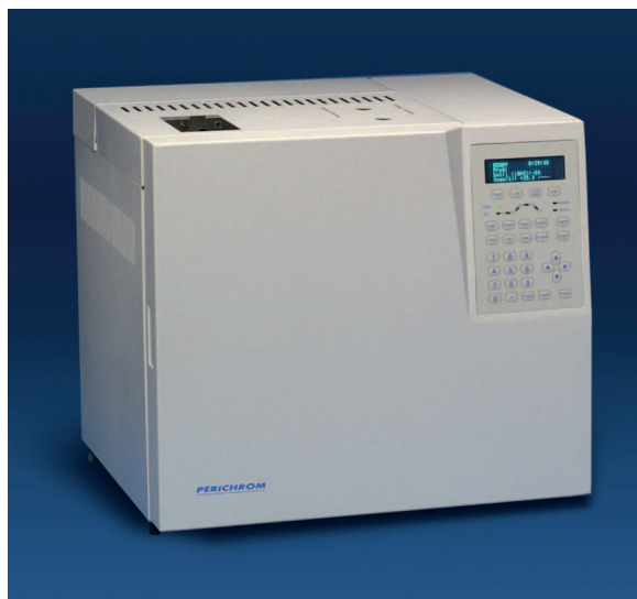
Chromatographe en phase gazeuse – Perichrom – Source de Ni63
