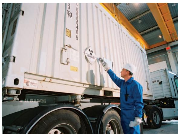
Contrôle radiologique d'un camion à l'aide d'un radiomètre dans le bâtiment logistique du centre de stockage pour les déchets de très faible activité (CSTFA) de l'ANDRA dans l'Aube
