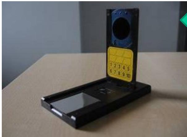
**Dosimètre passif Radon-Kodalpha utilisé pour la mesure intégrée du dépistage**
