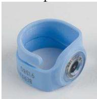
Figure 7 Bague dosimétrique
