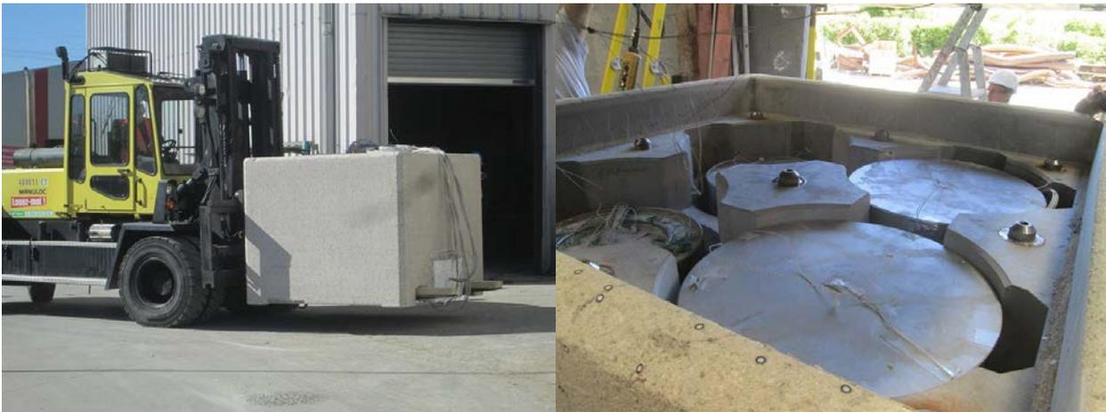
Figure 2.2-5 Manutention et ouverture du colis CS4 après l'essai incendie
