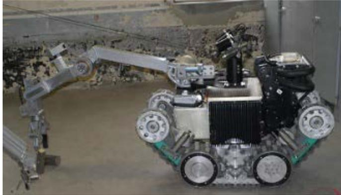
Figure 3.1-5 Illustration d'un robot d'intervention en milieu irradiant
