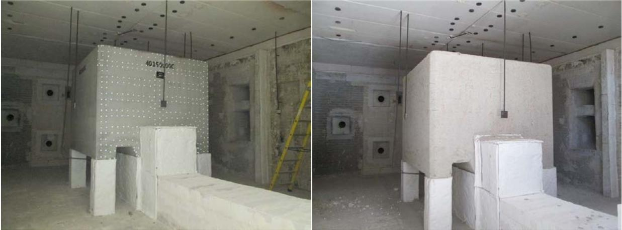
Figure 2.2-3 Colis CS4 avant (à gauche) et après l'essai incendie (à droite)
