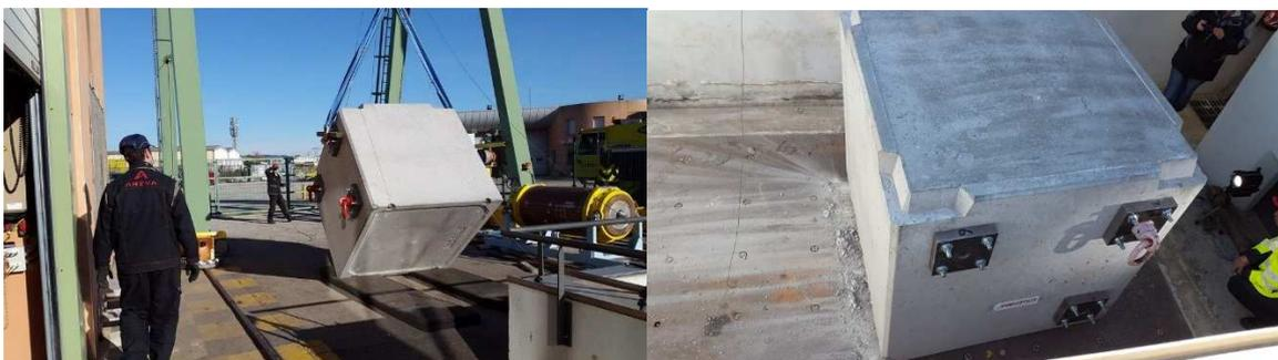
Figure 13 : Essais de chute d'un CBFK pour sa qualification IP2
