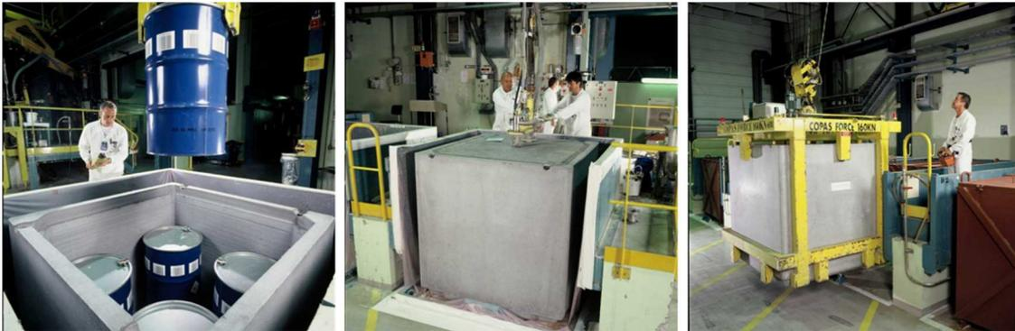
Figure 7 : Opérations industrielles actuelles de constitution de colis CBFK à Marcoule : Exemple pour 5 fûts de déchets radioactifs dont 1 à 3 peuvent être des fûts de déchets bitumés
