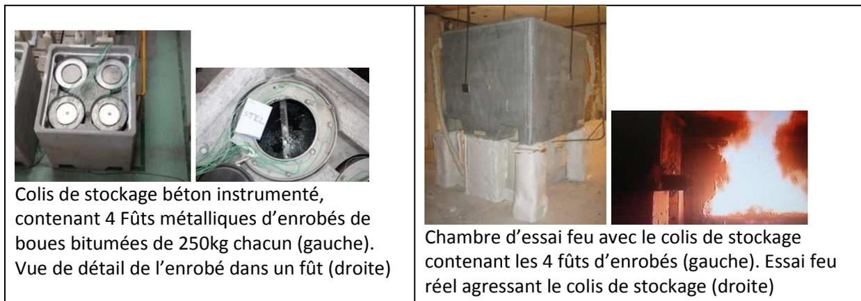
Figure 16 : Essais d'incendie d'un colis béton contenant 4 FEB à échelle 1
