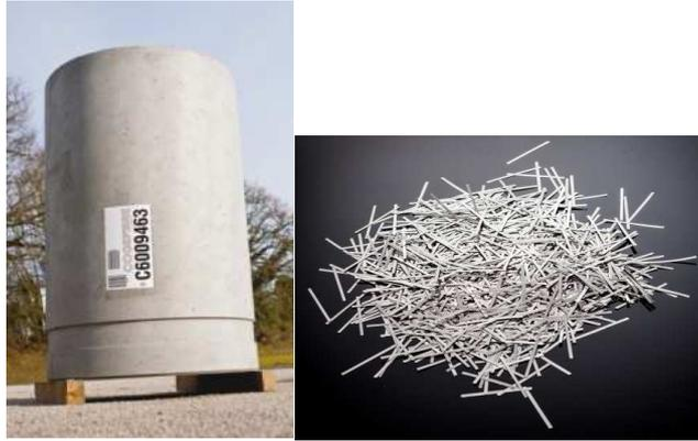
Figure 4 : Illustration coques cylindriques en béton fibre et des fibres métalliques du béton fibre
