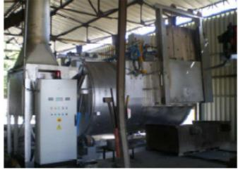
Le four présente la capacité de basculer de 30° vers l'avant et de faciliter ainsi la récupération des pièces métalliques (inserts non fondus) sans avoir à utiliser de panier.
