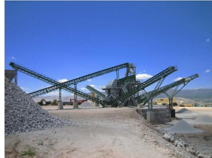
Installation de concassage criblage et mise en tas. 250 t/h
