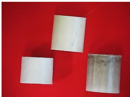
**Figure 5 : Pastilles de thorium frittées à partir de poudres de ThO<sub>2</sub>, avec des densités entre 83 et 92% TD.**
