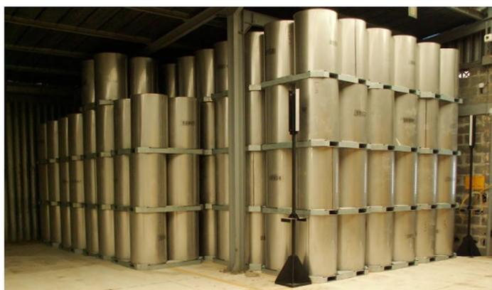
**Figure 4 :** Entreposage actuel des conteneurs en acier inoxydable du nitrate de thorium Areva à Cadarache.
