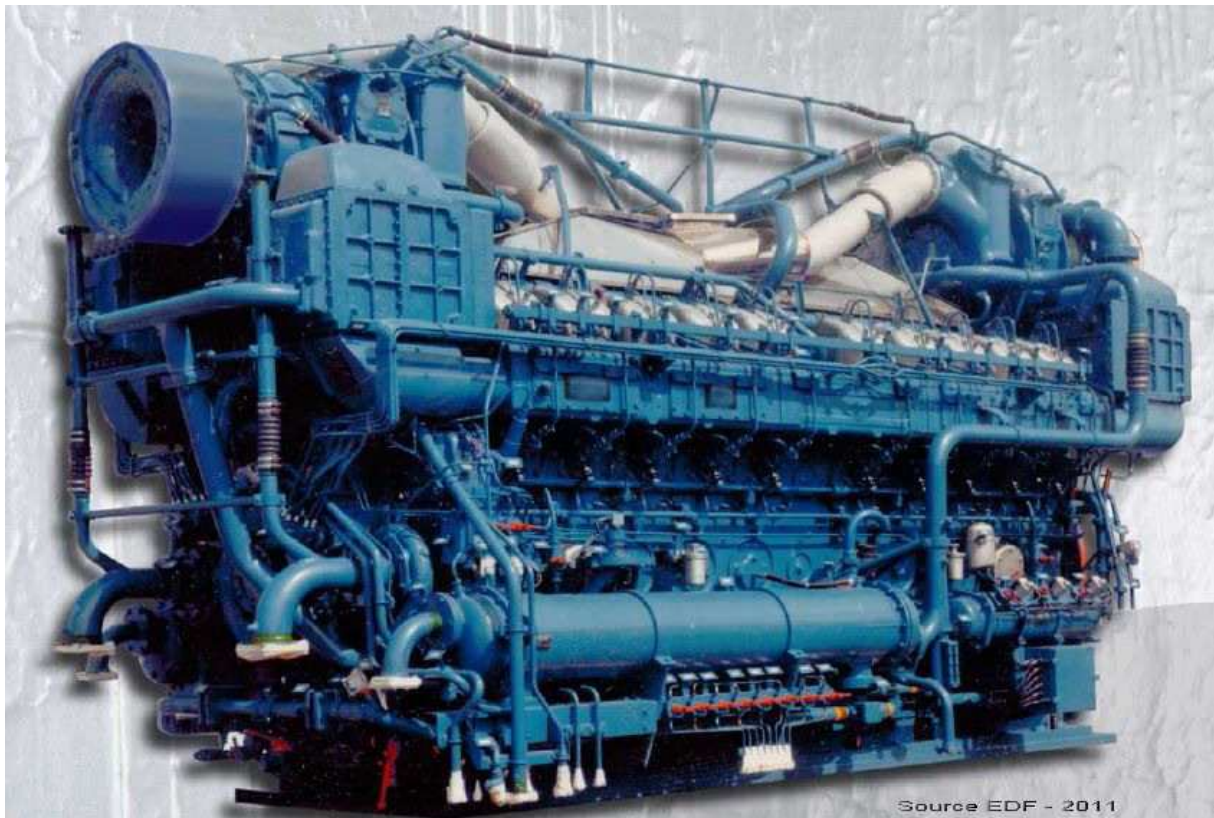
Groupe électrogène à moteur diesel équipant les réacteurs électronucléaires de 900 MWe
