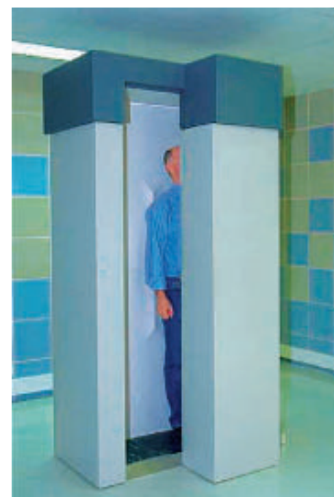
Dispositif de mesures de contamination radioactive (mains, pieds, corps entier) placé à la sortie de zone contrôlée.
