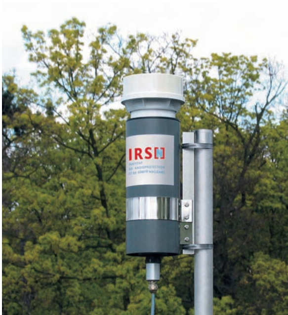
Balise TELERAY permettant la surveillance du débit de dose ambiant
